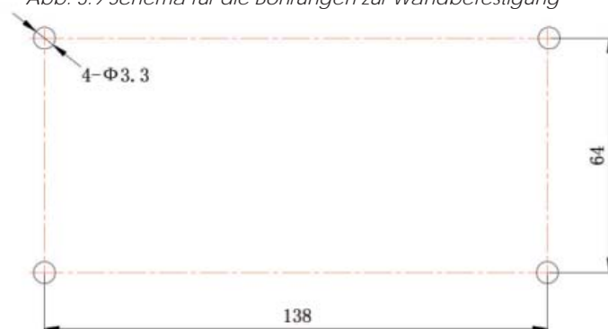
Abb. 3.10 Installationsbohrungen der hinteren Abdeckung des Schaltkastens
