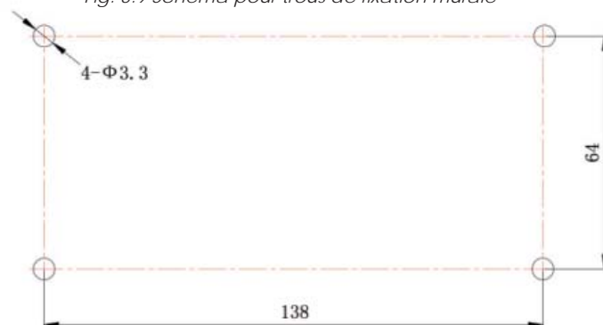
Fig. 3.10 Trous d'installation du couvercle arrière de l'armoire électrique
