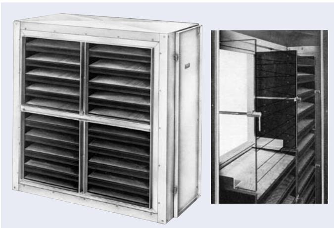
Carcaça em chapa de aço galvanizada, tendo lateralmente uma porta de inspeção para a troca dos elementos filtrantes. A disposição da porta é normalmente à direita, no sentido do ar, podendo ser fornecido também com porta à esquerda. A moldura da carcaça com ampla superfície de junta serve ao mesmo tempo como moldura de conexão para dutos ou aparelhos.
